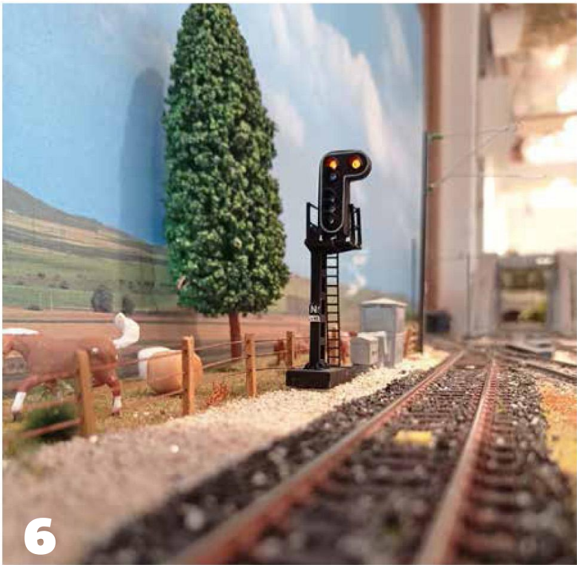
6: Un signal présentant un avertissement 30 commandé par le décodeur CDF.
