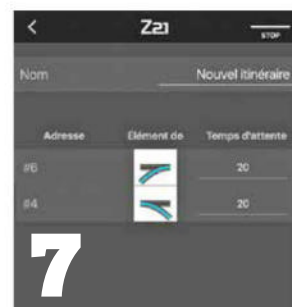
Fig. 6. TCO avec position des aiguilles sélectionnées pour l'itinéraire, ici direct.
