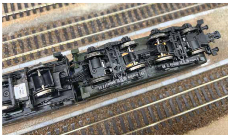
Pas vraiment un problème de fiabilité : les bandages d'adhérence de cette Chapelon Roco ont séché et se sont disloqués. Une bonne conception et la disponibilité des pièces chez les détaillants faciliteront la remise en route.
