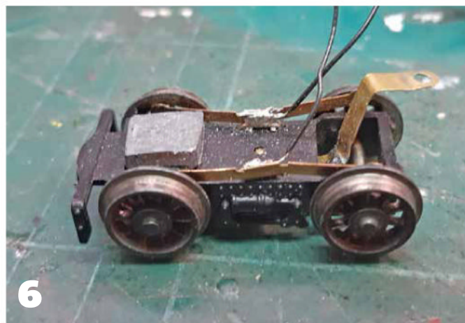
3: Grâce à ses roues bandagées, le bogie moteur tracte bien.
