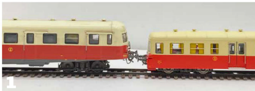
Les tampons du X 2800, à gauche, sont bien plus hauts que ceux du X 3800, à droite.
