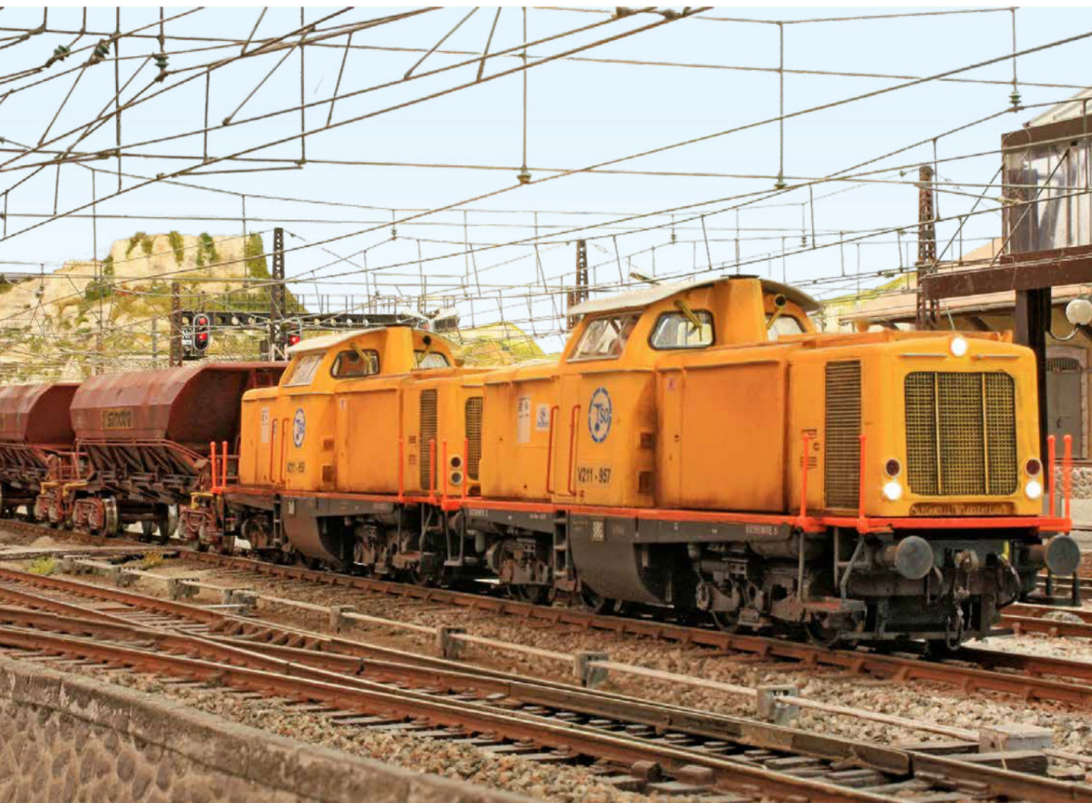
UNE UM D'ANCIENNES ALLEMANDES DE TYPE V211 ET SON CONVOI DE WAGONS-TRÉMIÉS EN ROUTE VERS LE CHANTIER.
