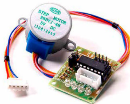
FIGURE 13 MOTEUR PAS À PAS UNIPOLAIRE ET SA CARTE DE COMMANDE AVEC CIRCUIT ULN2003.
