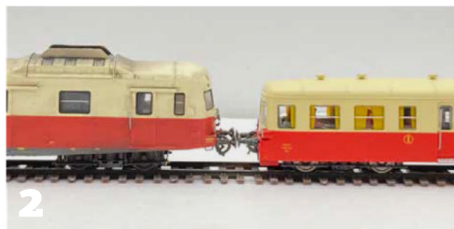
Après modification, la hauteur des tampons est semblable sur les deux engins.
