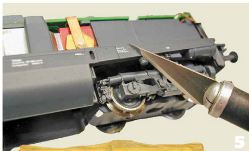
3 Modification du bogie. En réalité, on peut assurer la découpe directement sur la machine, mais avec délicatesse
