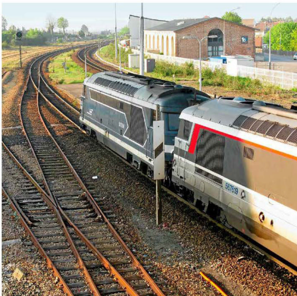
En sortie de gare côté Abbeville, le signal à Voie Libre peut aussi présenter l'avertissement précédant le sémaphore de cantonnement.
