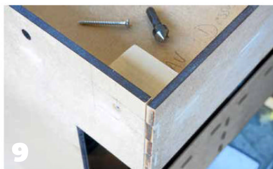
9: Des blocs de bois sont collés au dessus du toit et en appui contre les flancs. Après perçage et vissage, le toit ne peut plus ressortir, mais reste démontable après retrait des vis.
