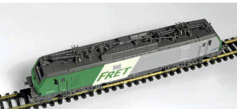
La toiture de cette BB 37000 comporte, comme il se doit, les trois pantographes .
