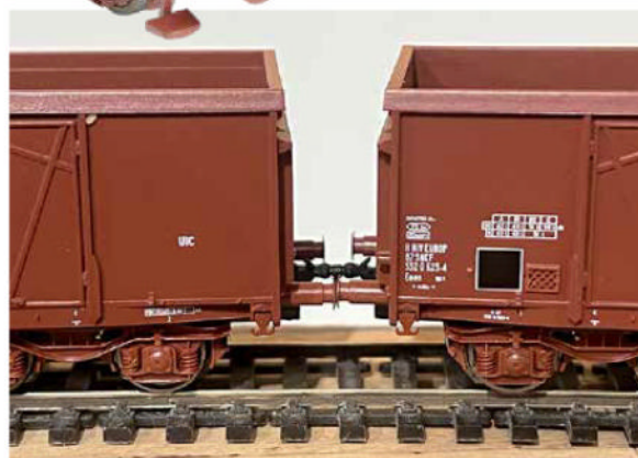
En courbe, l'ensemble se comporte comme un timon rigide qui agit sur le dispositif à élévation.
