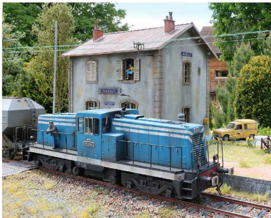
La BB 4036 CFTA est une construction intégrale faisant appel aussi bien à la carte plastique qu'au laiton. Sa motorisation et ses bogies proviennent d'une locomotive V-100 Lenz. Comme tous les autres engins-moteur circulant sur ce réseau, elle est digitalisée et sonorisée.
