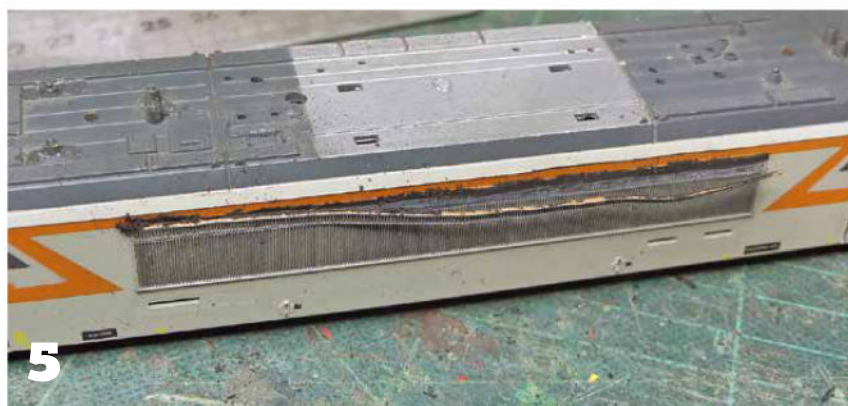
5: Découpe et arasage du filtre Roco d'origine à la scie disque et lame cutter plate n°17, avant aplanissement à la cale à poncer.
