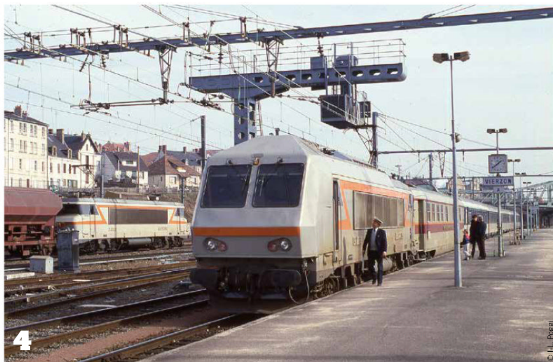
4: Les BB 22351 à 22360 sont équipées filtres spécifiques TGV Atlantique en six panneaux, avec bande orange plus large entre le filtre et la toiture.
