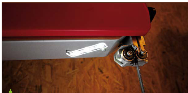
La grande Einhell bénéficie d'un éclairage intégré au boîtier du volant supérieur. C'est beaucoup moins encombrant que la lampe sur flexible de la Ryobi, mais du coup la lampe a tendance à éclairer un peu à côté de la zone prioritaire.
