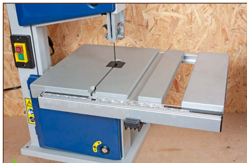
Une intéressante extension de table latérale équipe la grande et la petite Scheppach. Son levier de blocage est ici à l'horizontale, en position déverrouillée ; l'extension est bloquée quand il est enfoncé vers le bas.
