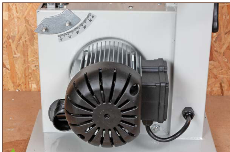
Sur les trois plus petites scies, l'entraînement est direct, ce que l'on voit ici (petite Scheppach) avec le moteur parfaitement centré sur le boîtier du volant inférieur.
