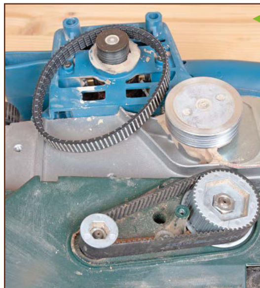
Les courroies d'entraînement se trouvent plutôt dans des outils à moteur transversal, tels que les rabots (en bas) ou les ponceuses à bande [en haut]. Ce sont des courroies dentées/crantées (1) ou des courroies dites poly-V (2). Sur les machines semi-stationnaires, on peut aussi trouver des courroies trapézoïdales (3). Les courroies plates sont plus rares sur les matériels récents. Toutes se trouvent aisément, il existe même des sites internet spécialisés dans les courroies.
