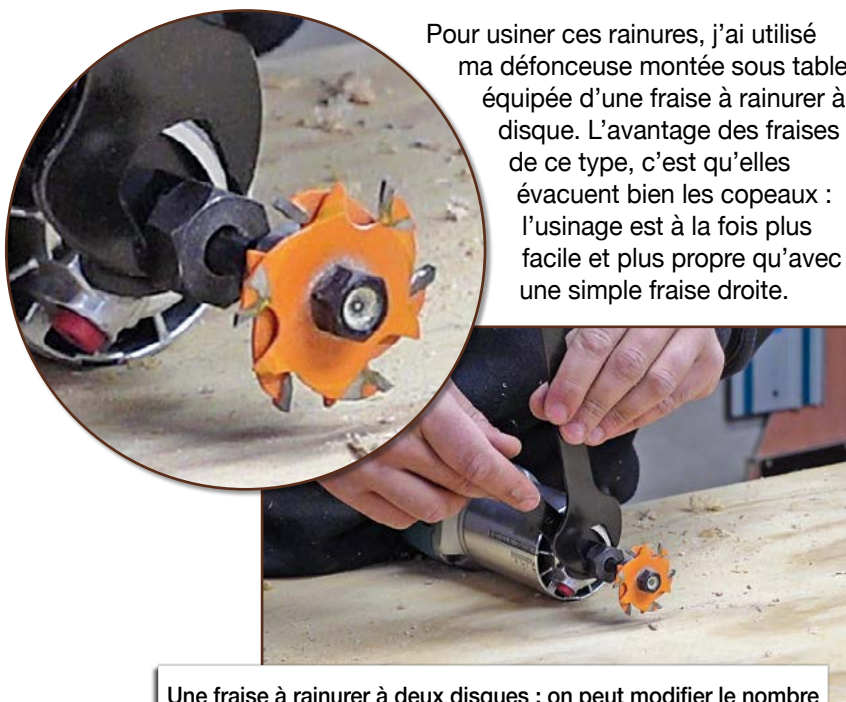
Une fraise à rainurer à deux disques : on peut modifier le nombre de disques selon le besoin et l'épaisseur de la rainure.
