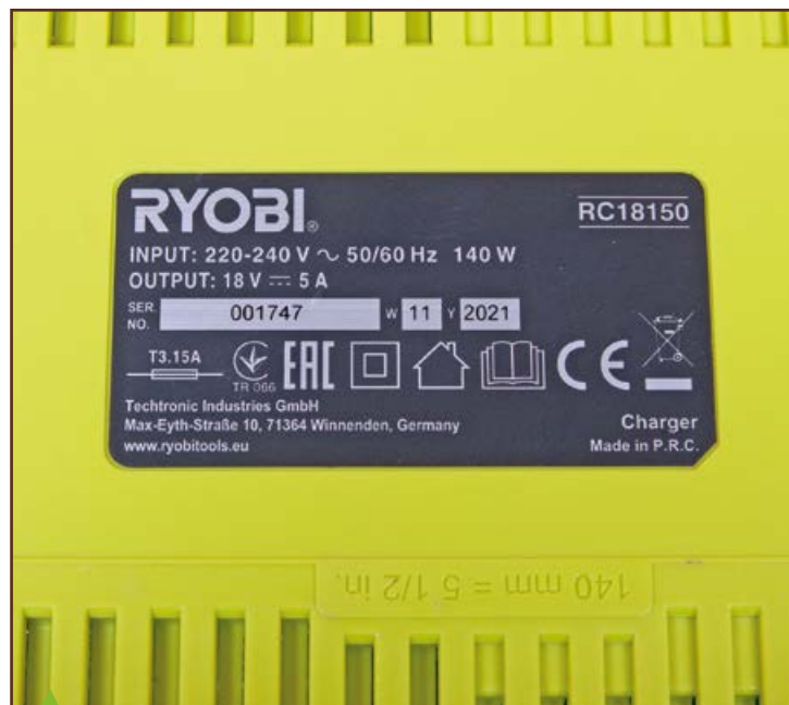
La caractéristique la plus importante d'un chargeur est de fait peu visible : elle figure sur l'étiquette, généralement dissimulée sous l'appareil... quand il y en a une. Sur ce chargeur 18 V Ryobi, elle est de 5 A, garantissant une bonne vitesse de charge, mais sur mon autre chargeur Ryobi, bien plus sommaire, il n'y a aucune indication !
