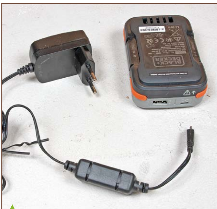
Solution minimaliste : le chargeur USB qui se connecte directement à la batterie, sans aucune électronique de contrôle, ici le chargeur et la batterie d'un pistolet à colle Black+Decker. Ceci étant, le gros chargeur Hikoki dont je dispose est également doté d'une sortie USB.
