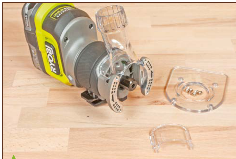
Et sur la Ryobi, le capteur vient remplacer la plaque de fermeture arrière.
