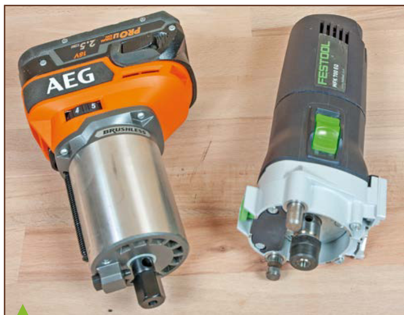
Qu'il s'agisse de modèles avec batterie ou à fil (la Bosch Pro), la plupart des affleureuses s'insèrent dans leur base par un emmanchement cylindrique. La Festool fait exception avec un système à deux ergots.
