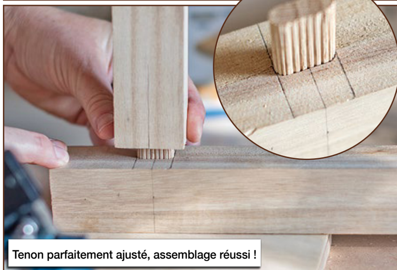
Usinage des traverses en bois de bout
